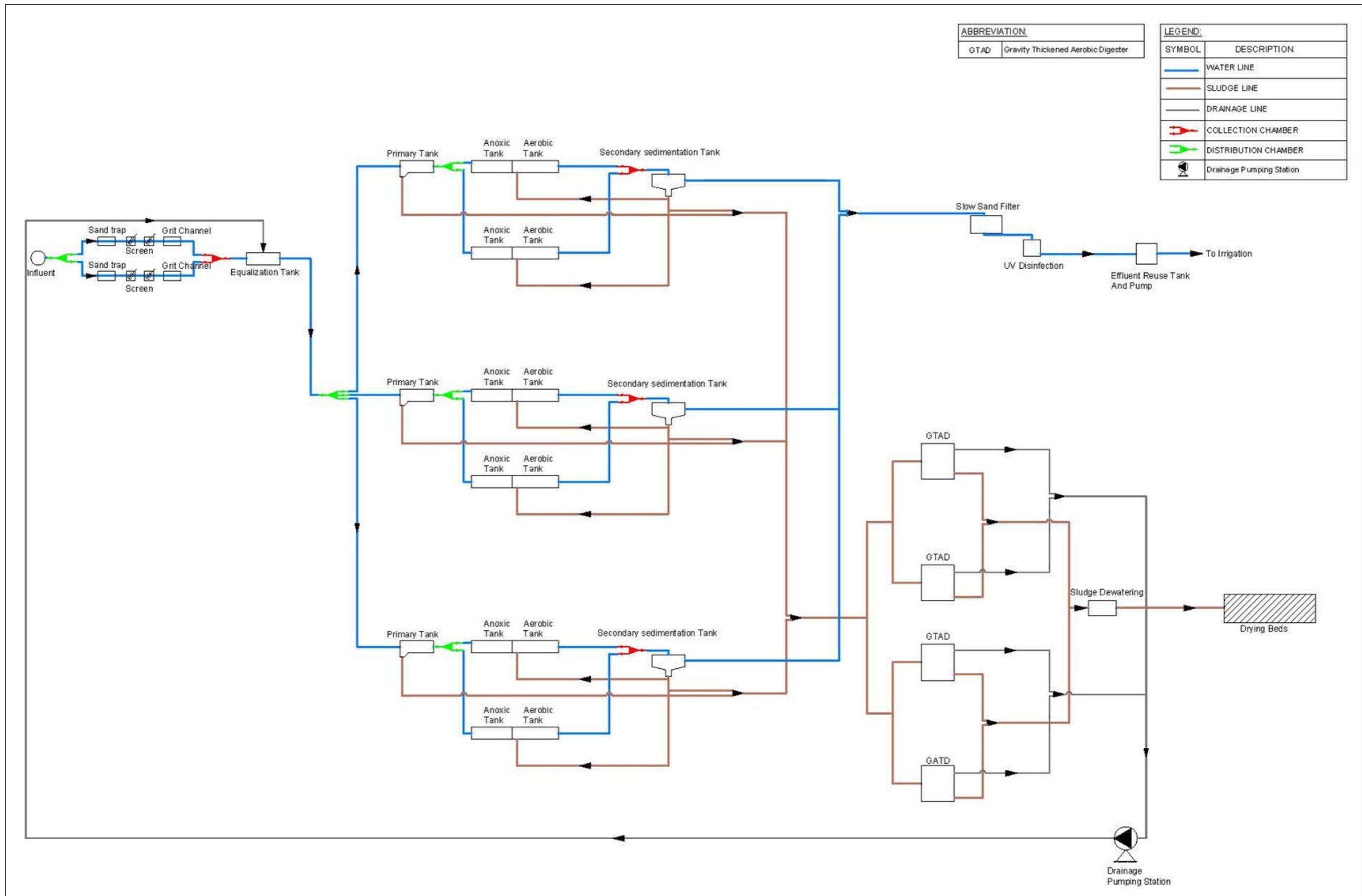
الشكل 2. شكل توضيحي لمخطط مراحل المعالجة في محطة الغباري لمعالجة الصرف الصحي
